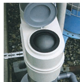
▲写真② フロートが上昇した状態
